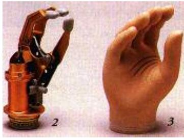
Für 8 - 14-jährige Kinder steht bereits eine myoelektrische Hand zur Verfügung, welche sich von 6 3/4" über 7", 7 3/4" und 8" nahtlos und kompatibel in das myoelektrische 6 Volt-System der Erwachsenen einfügt.
